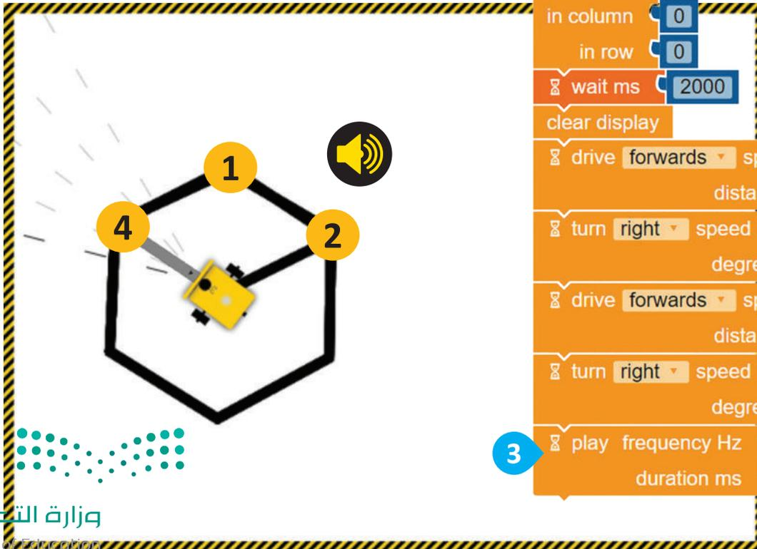
عليك الآن برمجة الروبوت لتكرار الخطوات السابقة مرتين ليتحرك ويرسم المعين باستخدام لبنة التكرار ( ) مرة ( ) times.
