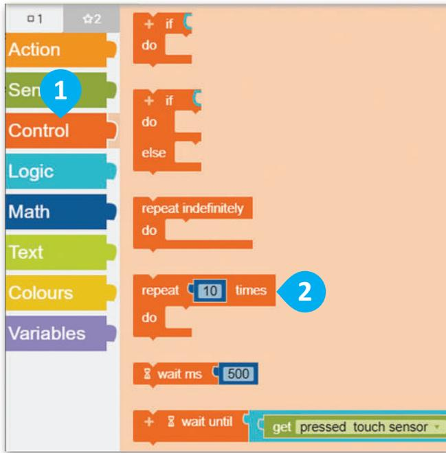
لكي يتحرك الروبوت ويرسم مستطيل، يمكنك برمجته لرسم الجانبيين، وللقيام بذلك، استخدم لبنة التكرار ( ) مرة (repeat ( ) times)، واضبط عدد التكرارات إلى 2، ثم ضع اللبنتين داخل لبنة التكرار، وسيقوم الروبوت بتكرار جميع الخطوات المطلوبة.
