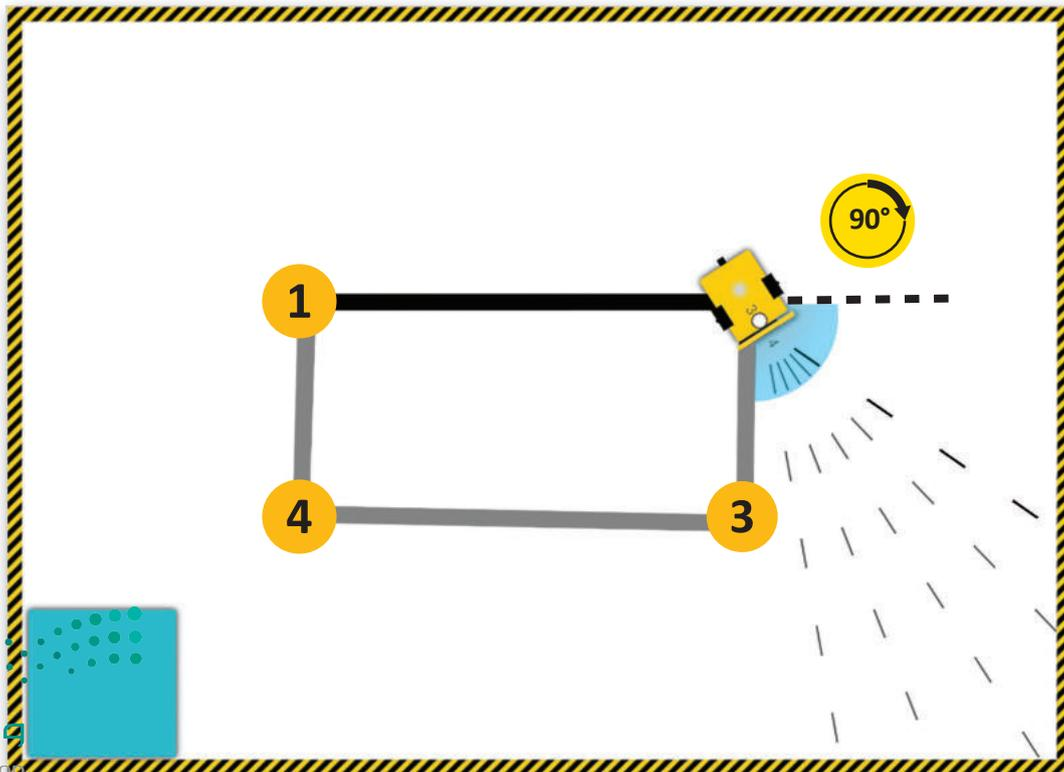
بعد ذلك، عليك برمجة الروبوت لكي يتحرك للأمام لمسافة 50 سم. وللقيام بذلك، استخدم لبنة القيادة (drive) مع ضبط معامل المسافة بالسنتيمتر (distance cm) إلى 50.
