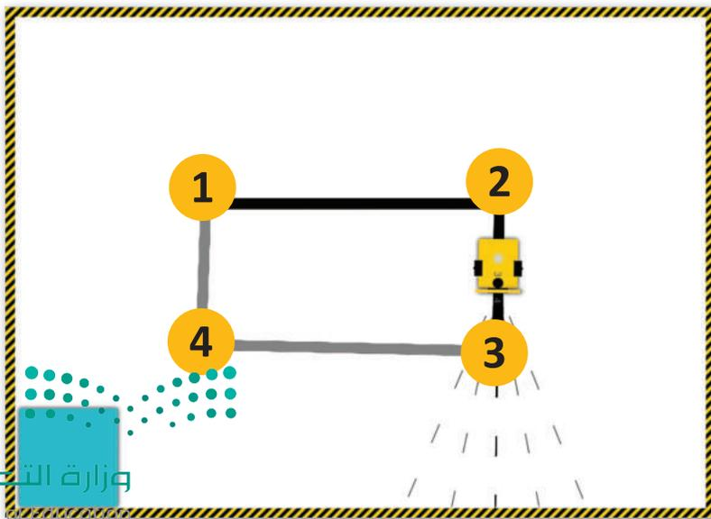
الآن، عليك برمجة الروبوت للانعطاف نحو اليمين، وللقيام بذلك، استخدم لبنة **الانعطاف (turn)** مع ضبط معامل السرعة (speed) إلى 30، ومعامل الدرجة (degree) إلى 90.
