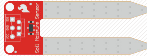
مُستشعر رطوبة التربة (Soil Moisture Sensor)
