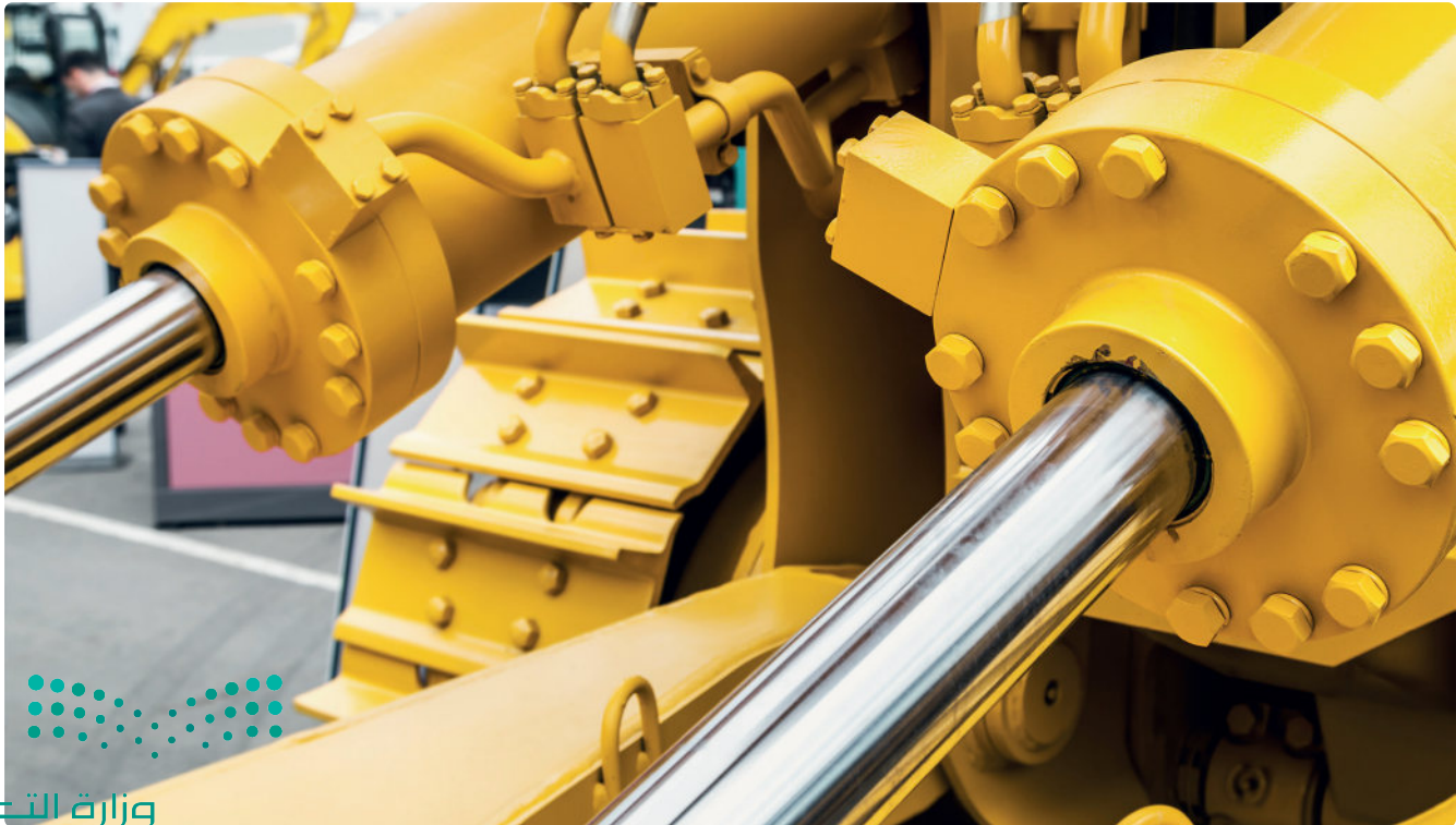
شكل 1.15: نظام مُشغل هيدروليكي (مكبس) للآلات الثقيلة
