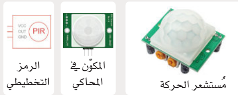
شكل 3.5: مُستشعر الحركة (PIR sensor)
