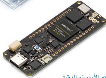
شكل 3.1: لوحات أجهزة تحكم الأردوينو الدقيق
