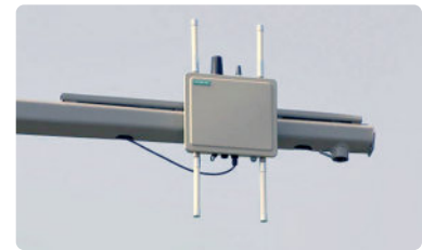
شكل 7.6: وحدة على جانب الطريق (RSU)
