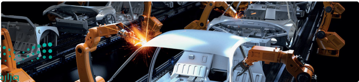
شكل 1.4: خط تجميع روبوتي في مصنع سيارات
