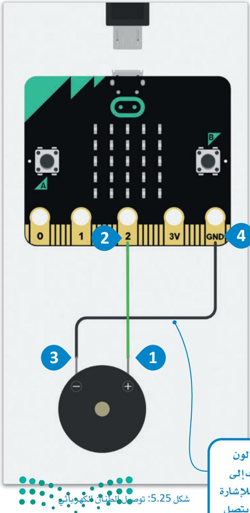
شكل 5.25: توصيل الطنان الكهربائي
