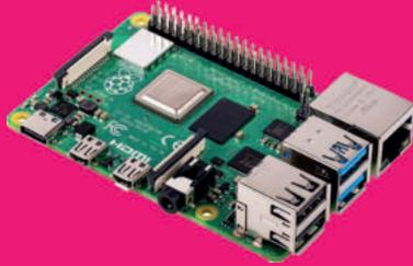
يرى البعض أن جهاز رايزبيري باي (Raspberry Pi) هو جهاز تحكم دقيق مثل أردوينو (Arduino)، ويُعد جهاز رايزبيري باي بمثابة حاسوب صغير الحجم يمكن توصيله مباشرة بشاشة وبملحقات إضافية أخرى مثل لوحة المفاتيح والفأرة، ويمكن أيضاً تحميل نظام تشغيل كامل عبر بطاقة ذاكرة محمولة (MicroSD memory card) في هذا الجهاز.
